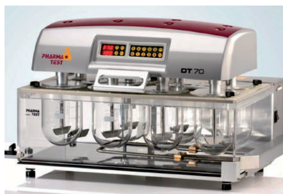
Fig. 1. Aparato de disolución USP tipo II utilizado en el ensayo.
